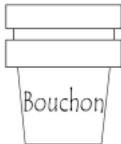
Un matériaux intéressant à utiliser est la butée de porte : il sera vraisemblablement nécessaire de modifier un peu sa forme en le tournant à l'aide d'une perceuse par exemple...
