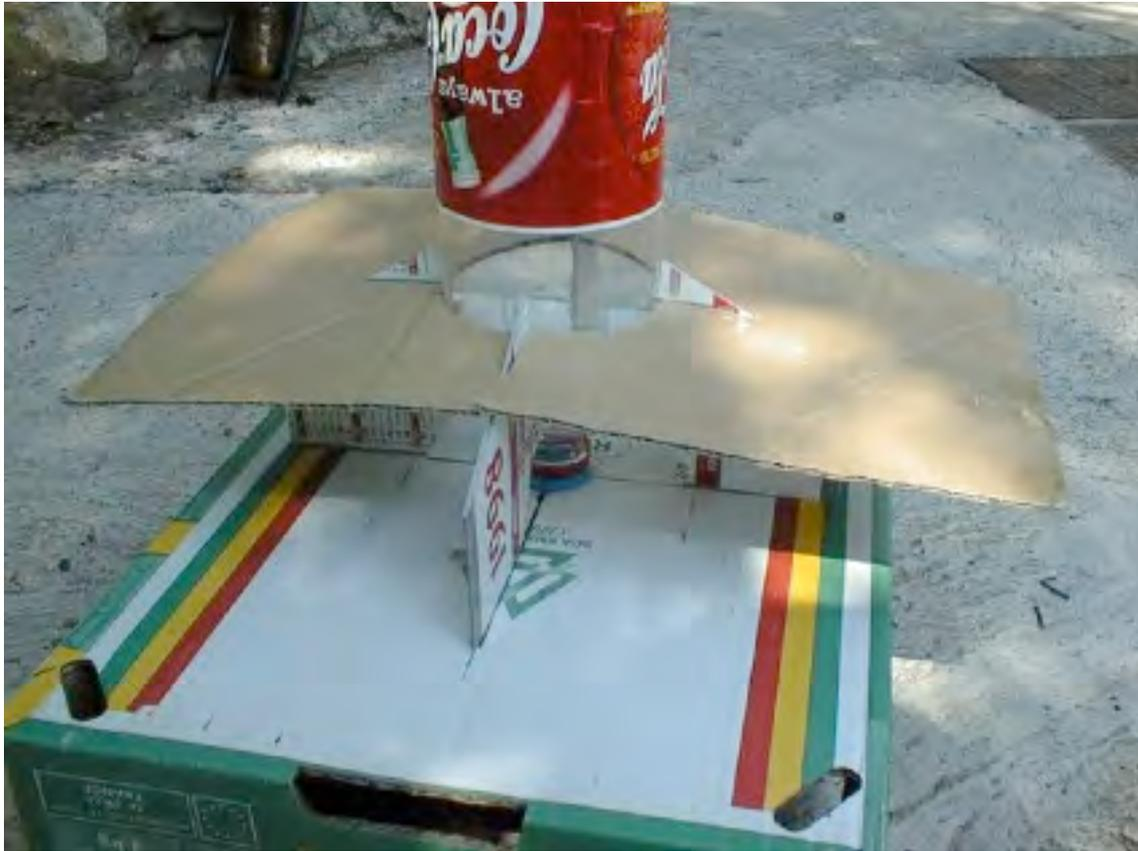
Figure 37 : Une méthode de collage d'ailerons
