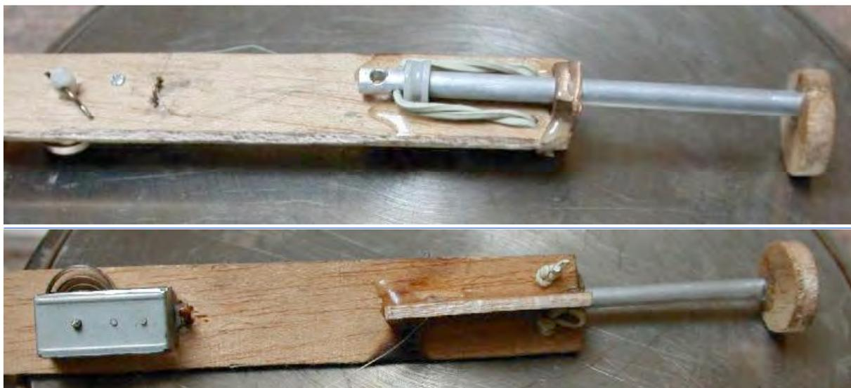
Figure 67 : Catapulte maintenue par minuterie mécanique
