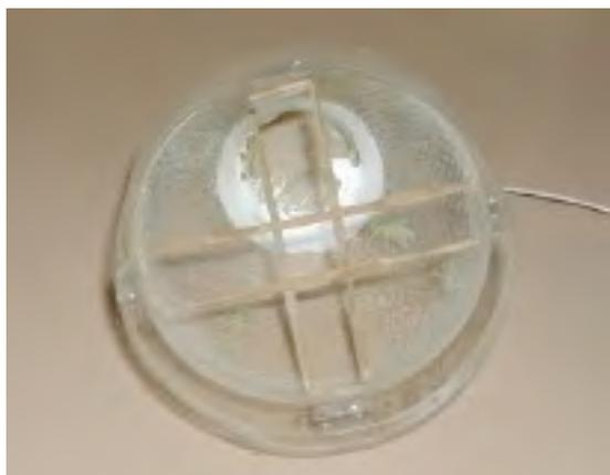
Figure 62 : Croissillon d'élastique pour l'éjection du cône
