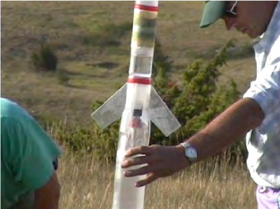
Figure 82 : Vue sur le système de séparation d'une fusée bi-étages
