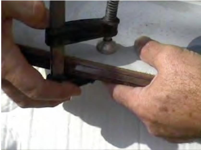
Figure 32 : Collage en serrant l'aile entre deux planches bien planes
