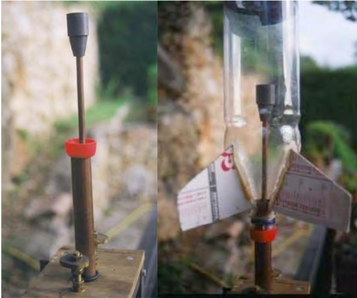
Figure 26 : Utilisation d'un réducteur de diamètre de tuyère
